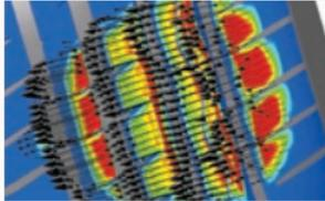
Lateralkraft bei Schräglaufwinkel von 12°
