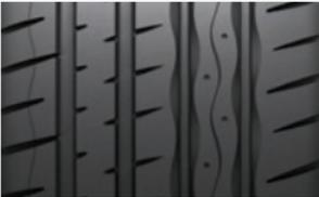
Durchgehendes Rippenprofil verbessert die Längssteifigkeit.
