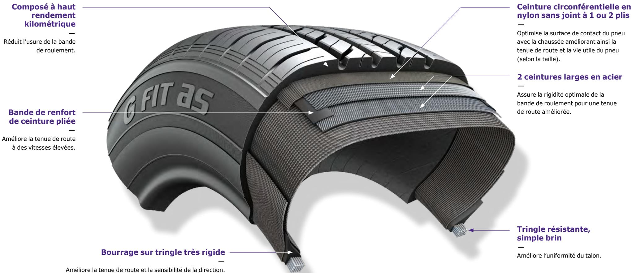
\* La taille du modèle dans le diagramme structurel est pour le pneu 185/65R15H, et les descriptions des diagrammes structurels peuvent varier selon la taille.
